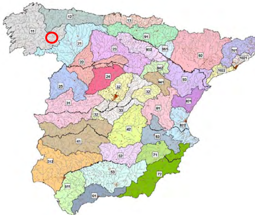
Figura 4.3.- Regiones consideradas para la caracterización del coeficiente corrector del umbral de escorrentía (norma 5.2-IC, 2018).
